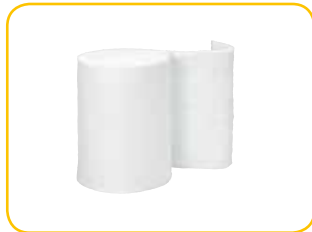
Keraaminen eriste Palamaton eristematto, paksuus 13 mm, leveys 610 mm, tilavuuspaino 128 kg/m 3 . Esim. tulisijaliitosten tiivistämiseen.
