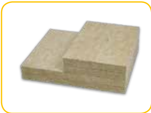
Läpiviennin eristepaketti Lämpötilaluokkaan T600, paksuus 100 mm. 4 eristelevyä / pkt, korkeus 600 mm.
