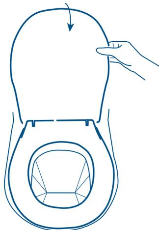
Fäll ner locket. (Förbränningen kan ej starta med locket öppet).
