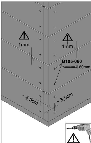
Bei der Montage der Blockbohlen **muss unbedingt darauf geachtet werden**, dass die Blockbohlen mit **ca. 1mm Abstand** und umlaufend auf die gleiche Höhe montiert werden. Bedingt durch die Lagerung kann es außerdem zu unterschiedlichen Deckbreiten der Blockbohlen kommen, das gleichen Sie bitte bauseitig während des Anbringens der Bohlen an. **Bei Nichtbeachtung können die Wandhöhen unterschiedlich ausfallen.**
