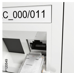
P120549 Liittimet käännetty johtojen irrottamisen helpottamiseksi.
