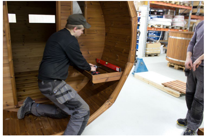
Asenna ulkoistuimet samalla tavalla kuin sisäistuimet.
