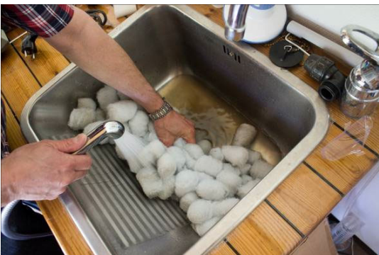
Purista suodatinpalloja että saat pois likaisen veden. Käytä esim. Filter Cleaner lian liottamiseen.
