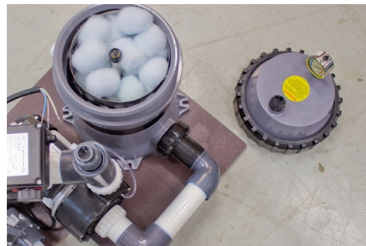
Purista suodatinpalloja että saat pois likaisen veden. Käytä esim. Filter Cleaner lian liottamiseen.
