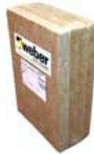
Multi, Basic ja DS Tandem läpivientieristesarjat Neljä 20 mm paksua, hormien mittoihin sovitettua palovillalevyä, jotka asennetaan Leca®-hormin ympärille esim. puuväli pohjan läpivientikohdassa.
