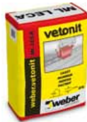
weber.vetonit ML Leca® Laasti hormiharkkojen ohutsaumamuuraukseen n. 5 mm:n saumalla. Menekki: Leca® Multi: n. 5 kg / jm Leca® Basic n. 7,5 kg / jm Leca® DS Tandem n. 14 kg / jm Pakkauskoko 25 kg säkki
