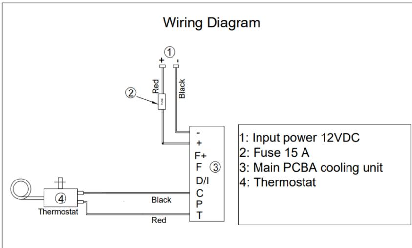
En 15A in-line sikring følger med fryseren for å beskytte ledningene. For drift på 12V skal en 15A sikring brukes. En standard bilsikring anbefales, og sikringen skal kobles til på den positive ("+") siden av systemet, nær den positive batteriterminalen.
