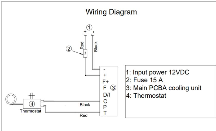
Pakastimen mukana toimitetaan 15A:n sulake johtojen suojaamiseksi. 12V:n toimintaan tulisi käyttää 15A:n sulaketta. Suositellaan tavallista auton sulaketta, ja sulake tulee kytkeä järjestelmän positiiviselle ("+" puolelle, lähellä positiivista akun napaa.
