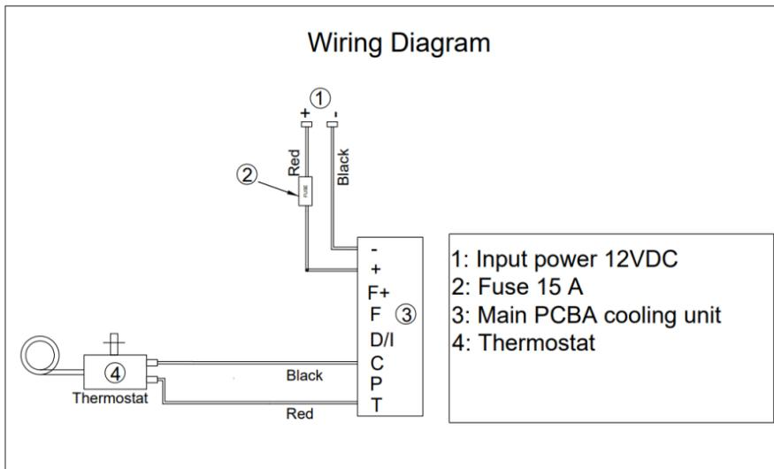
En 15A in-linesäkring medföljer frysen för att skydda kablarna. För drift vid 12V måste en 15A säkring användas. En vanlig bilsäkring rekommenderas och säkringen ska anslutas till den positiva ("+") sidan av systemet, nära batteriets pluspol.
