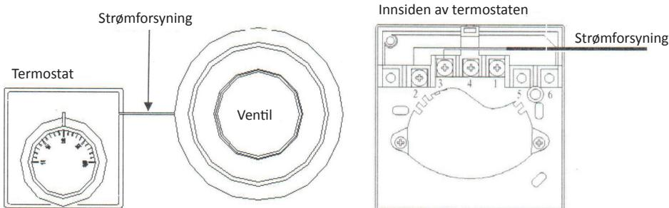
Monter termostaten på den indre veggen. Unngå å feste den direkte over ventilen.
