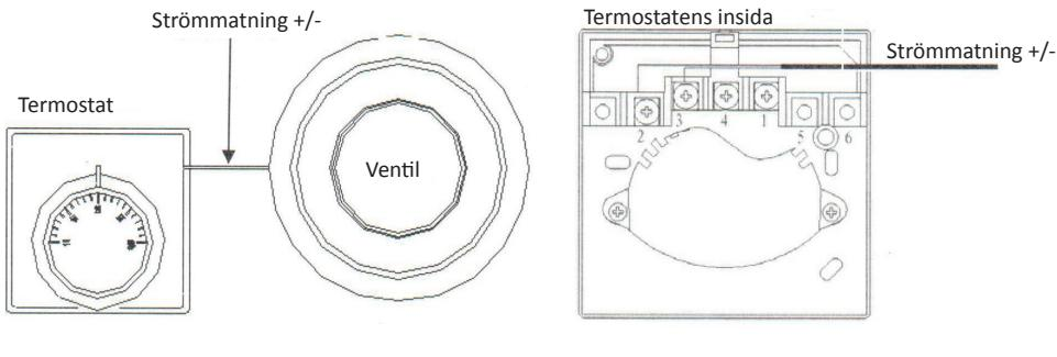
Montera termostaten på innerväggen. Undvik att placera den direkt ovanför ventilen.
