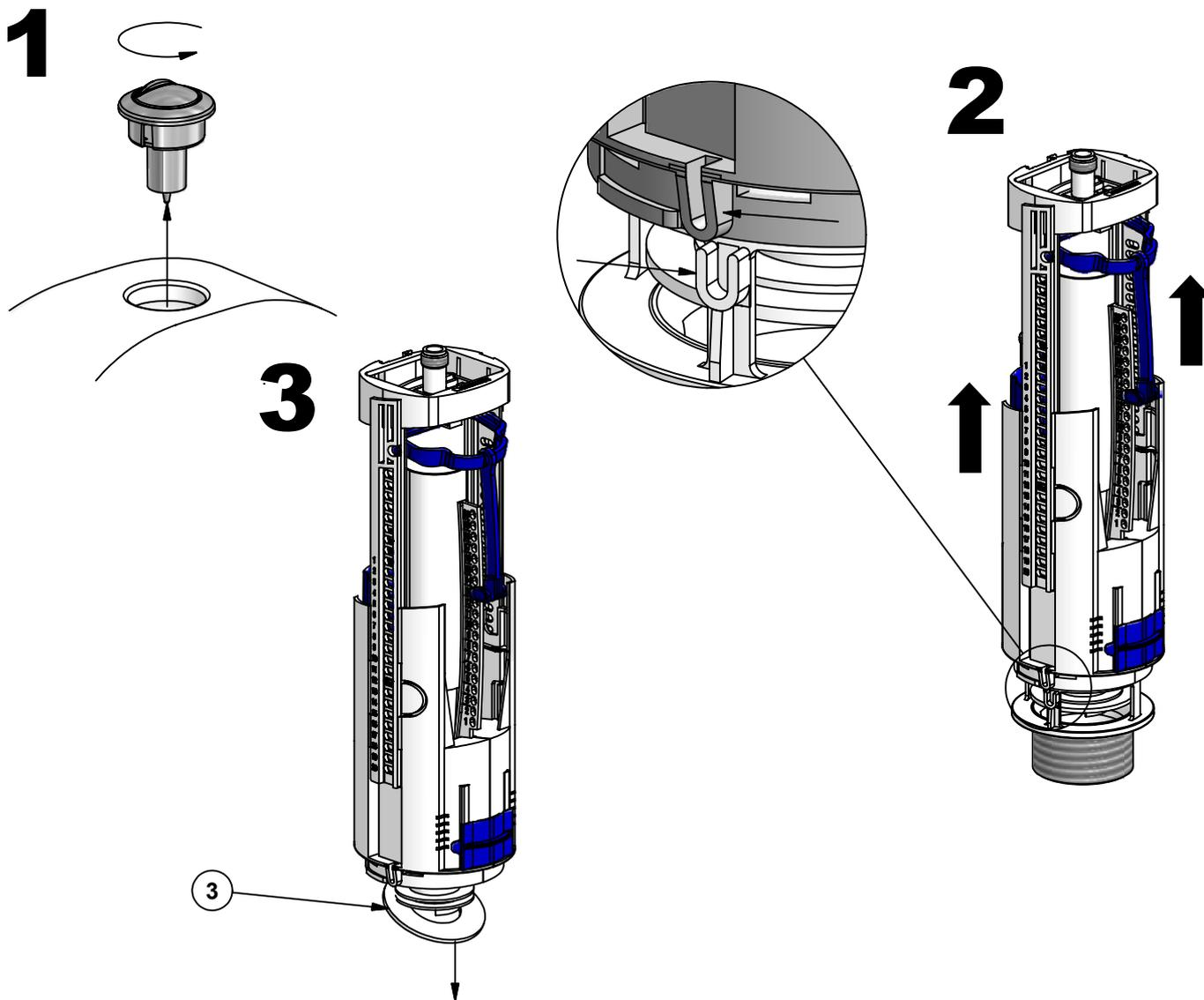
**S** Återmontera allt i omvänd ordning och sätt på vattnet.
