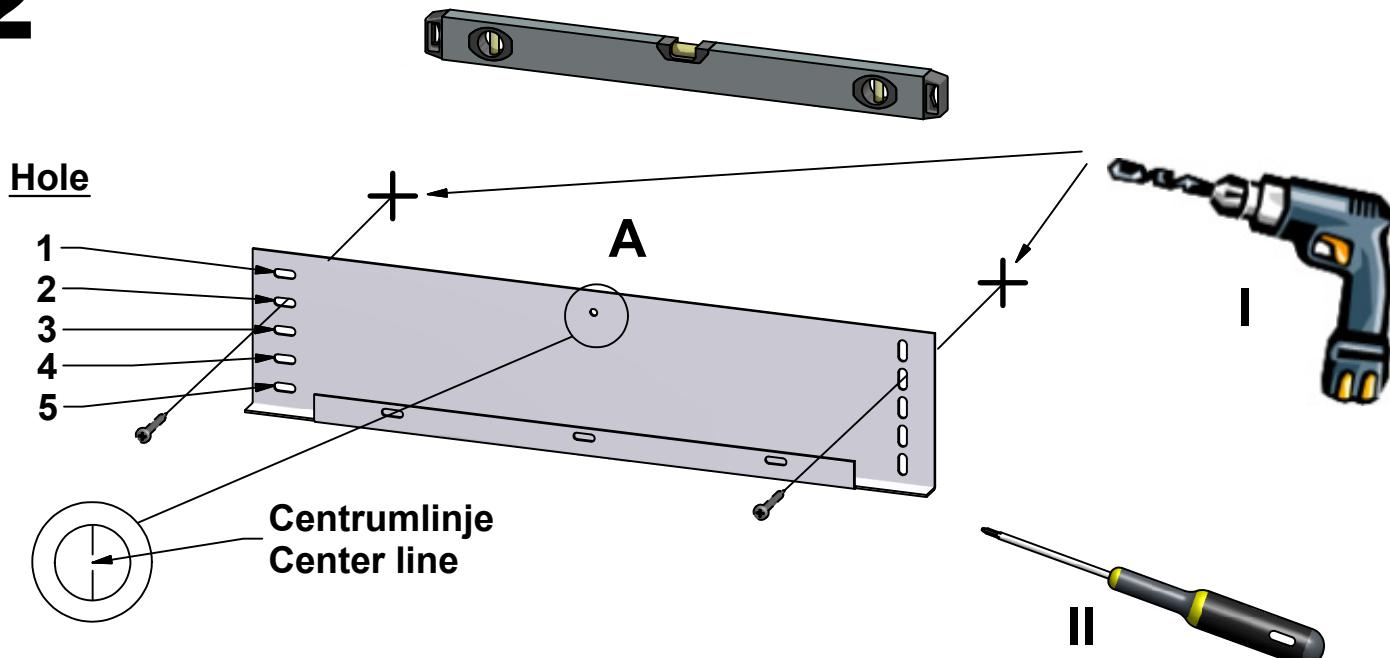
Skruvinfästningar i våtzon 1 ska göras i massiv konstruktion såsom betong, reglar, särskilda konstruktionsdetaljer eller i Vätrumsvägg 2012.
