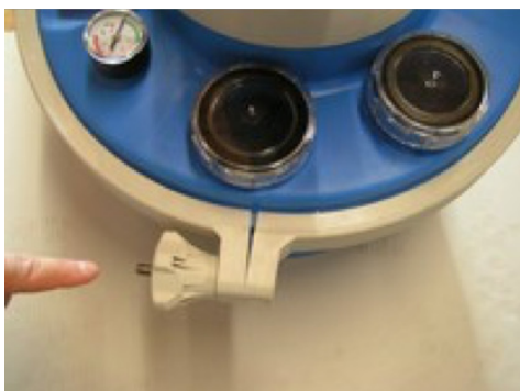
Foto 4.1a - Det følger med en strammingsknapp i plast for å stramme spennringen.
