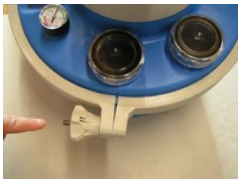
Kuva 4.1a - huomaa muovinen kiristysnappi, jolla letkuliitin kiristetään.
