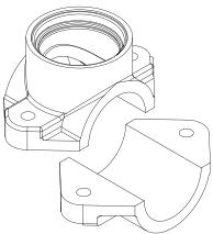
**Blue Fit50:** Anbörningsbygel för montering av Blue Connect i cirkulationssystemet (se sidan 17).<sup>3</sup>
