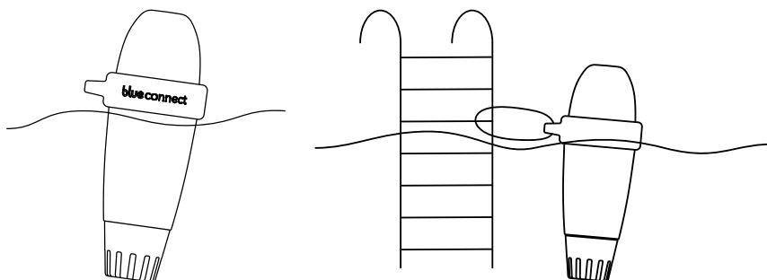
**NB :** Veillez à ce que l'appareil soit bien à la verticale et que la partie supérieure soit hors de l'eau pour assurer une communication correcte de l'appareil.
