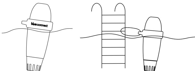
**Hinweis:** Achten Sie darauf, dass das Gerät senkrecht schwimmt und dass der obere Teil aus dem Wasser ragt, um eine fehlerlose Datenübertragung zu gewährleisten.
