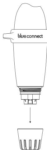
3. Limpie **Blue Connect** con un paño limpio y absorbente, prestando particular atención a secar correctamente la parte inferior del producto (donde se encuentra la sonda) sin tocar los sensores.
