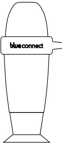
L'analizzatore **Blue Connect**: viene consegnato con il tappo per lo stoccaggio inserito per proteggere la sonda durante il trasporto. La sonda è immersa in KCl (cloruro di potassio saturo) che ne garantisce la protezione.
