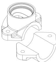
**Blue Fit50**: a abraçadeira de tubos para instalar o Blue Connect na tubulação dos locais técnicos (ver pág 17)<sup>3</sup>.
