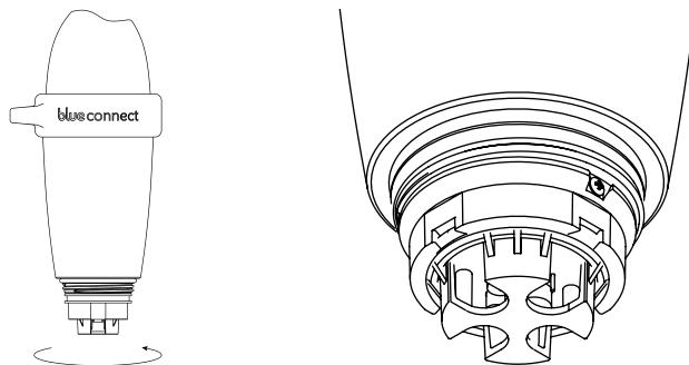
**7.** Enjuague la sonda con agua limpia y coloque la tapa de uso en la parte inferior del dispositivo para proteger las sondas.
