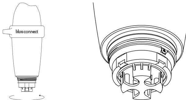
**7.** Molhe a sonda em água corrente e coloque a tampa na parte inferior do aparelho para o proteger.
