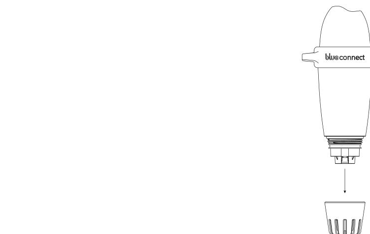
3. Veeg **Blue Connect** met een schone, absorberende doek af. Droog hierbij zorgvuldig de onderkant van het apparaat (daar waar de voeler zich bevindt), zonder de sensoren aan te raken.
