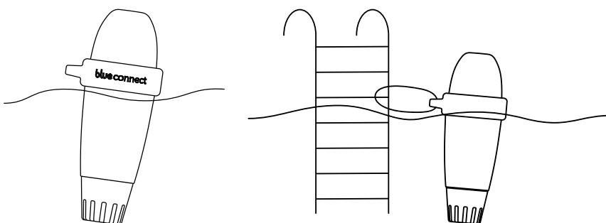
**Nota:** Verifique se o aparelho está na vertical e que a parte superior está fora da água, de modo a garantir a eficácia da comunicação de dados.
