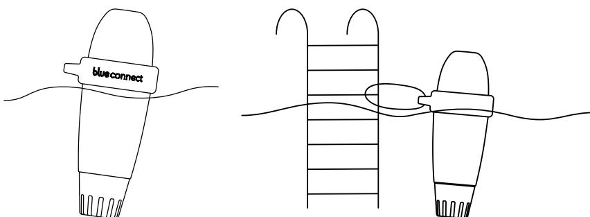
**OBS!** Se till att enheten är placerad vertikalt och att den övre delen är ovan vatten så att kommunikationen fungerar korrekt.
