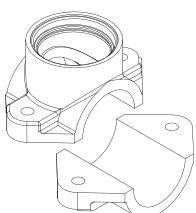
**Blue Fit50:** la abrazadera de toma para instalar **Blue Connect** en la tubería del cuarto de máquinas (consulte la página 17)<sup>3</sup>.
