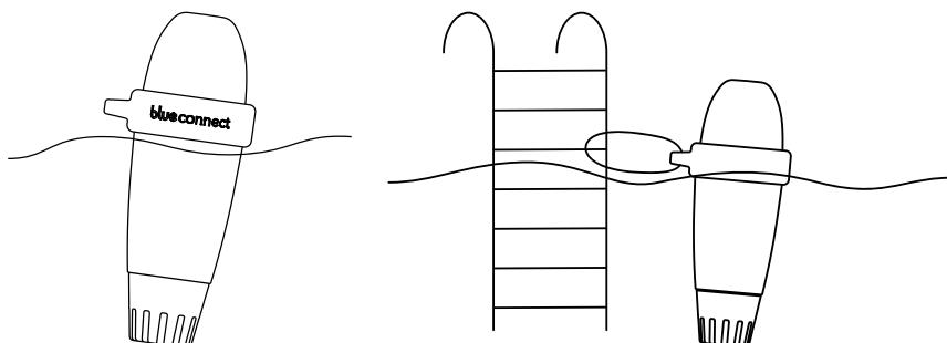
**Nota:** Asegúrese de que el dispositivo esté en posición vertical y de que la parte superior esté fuera del agua para garantizar una correcta comunicación del dispositivo.
