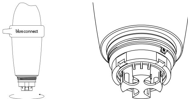
**7.** Risciacquare con acqua pulita la sonda e posizionare il coperchio sul fondo del dispositivo in modo da proteggere la sonda.
