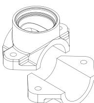
**Blue Fit50:** slangklem voor installatie van **Blue Connect** aan de buizen in de technische ruimte (zie pag. 17).<sup>3</sup>
