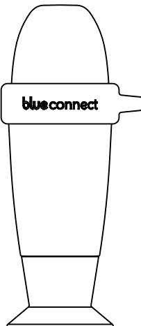
**El analizador Blue Connect:** Se entrega enroscado al tapón de almacenamiento a fin de proteger la sonda durante el transporte. La sonda está sumergida en KCl (cloruro de potasio saturado) para garantizar su protección.
