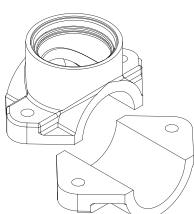
**Blue Fit50:** Schlauchklemme zur Installation von **Blue Connect** an den Rohren im Technikraum (siehe S. 17)<sup>3</sup>.
