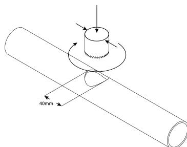
**3.** Placera anborrningsbygelns båda delar på vardera sida om röret så att hålet passar in, och skruva fast bygeln.
