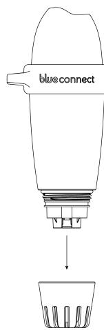
3. Wischen Sie **Blue Connect** mit einem sauberen, saugfähigen Tuch ab. Trocknen Sie dabei sorgfältig die Unterseite des Gerätes (dort, wo sich der Fühler befindet), ohne die Sensoren zu berühren.
