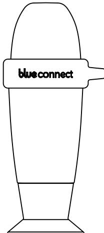
Aparelho **Blue Connect**: vem com o seu suporte de armazenamento para que esteja protegida durante o transporte. A sonda vem imersa em KCl (cloreto de potássio saturado) para garantir a sua proteção.
