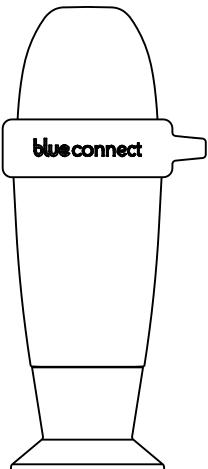
**Blue Connect** analysator: Sensorn levereras med kalibreringsfoten på som skydd under transport. Sensorn är nedsänkt i mättad kaliumklorid för bästa skydd.
