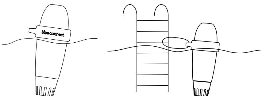
**Aanwijzing:** Let erop dat het apparaat rechtop drijft en dat het bovenste gedeelte uit het water steekt om een foutloze gegevensoverdracht mogelijk te maken.
