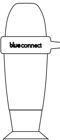
**Blue Connect** Analysegerät: Wird zum Schutz des Fühlers während des Transports in der Aufbewahrungskappe gesichert ausgeliefert. Der Fühler wird zum Schutz in KCl (gesättigter Kaliumchloridlösung) aufbewahrt.
