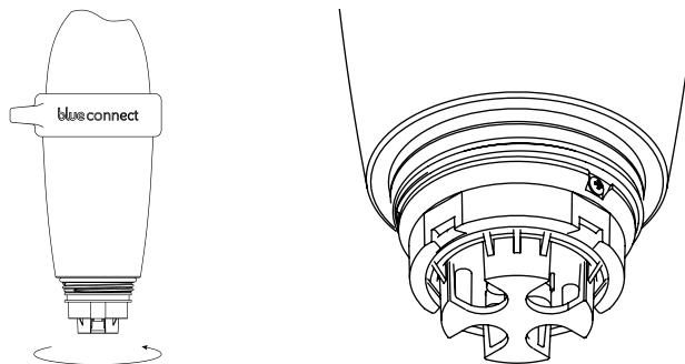
**7.** Rincez la sonde à l'eau claire et placez le bouchon d'utilisation sur la partie inférieure de l'appareil afin de protéger les sondes.
