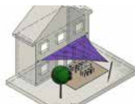
E1 1 x masto 2 x seinäkiinnitystä (Seinäkiinnikkeet)
