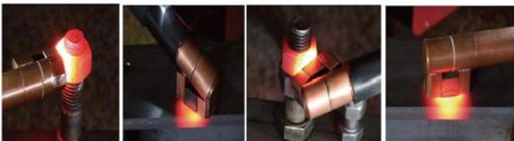
Ruostuneen mutterin kuumentaminen, jotta se voidaan poistaa nopeasti ja helposti koneista, autoista jne. Käytetään lämpölaajenemisteoriaa, jossa ruostuneen mutterin kuumennus saa sen laajentumaan, mikä helpottaa sen irrottamista. Samoin auton lasin lämmittäminen helpottaa sen poistamista autosta.
