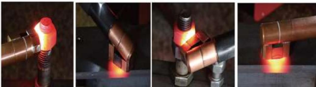
Uppvärmning av en rostig mutter så att den snabbt och enkelt kan lossas från maskiner, bilar etc. Genom att varma en rostig mutter expanderar den, vilket gör det lättare att ta bort den, enligt teorin om termisk expansion. På samma sätt blir det lättare att ta bort glaset från en bil om det värmes upp.
