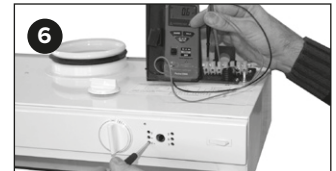
Voit tehdä mittauksen myös liitinrimalta, sähkökaavion osoittamista paikoista.
