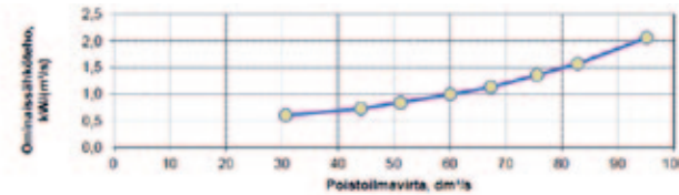
Oikein mitoitettu ilmanvaihtokone mahdollistaa pienen puhaltimien sähkönkulutuksen.
