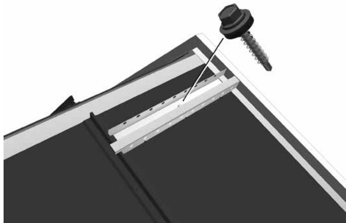
Kuva 33. Progantti harjan tiivistyslistan kiinnitys.
