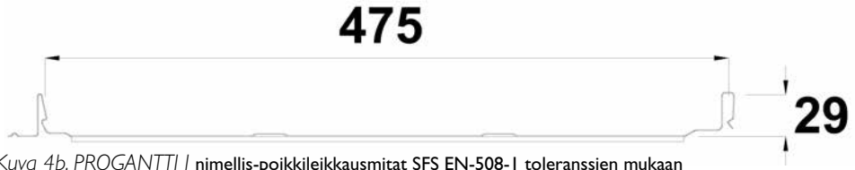
Kuva 4b. PROGANTTI J nimellis-poikkileikkausmitat SFS EN-508-1 toleranssien mukaan
